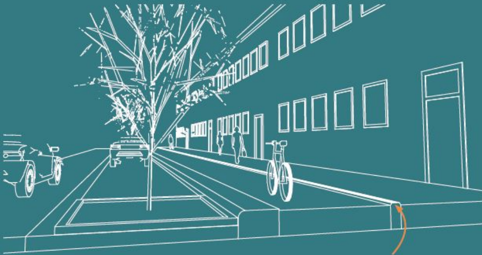
Radverkehrsführung auf Gehwegniveau
