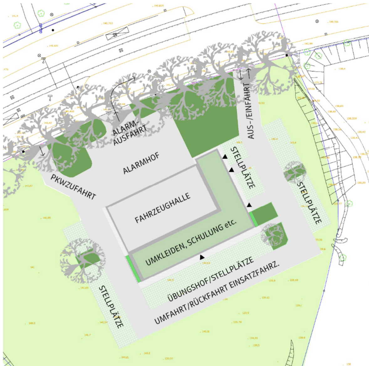
Schematische Funktions- und Flächenzuordnung als Grundlage für die Freiflächenplanung (Zeichnung: Stadt Kassel – Umwelt- und Gartenamt, ergänzt: akp_)
