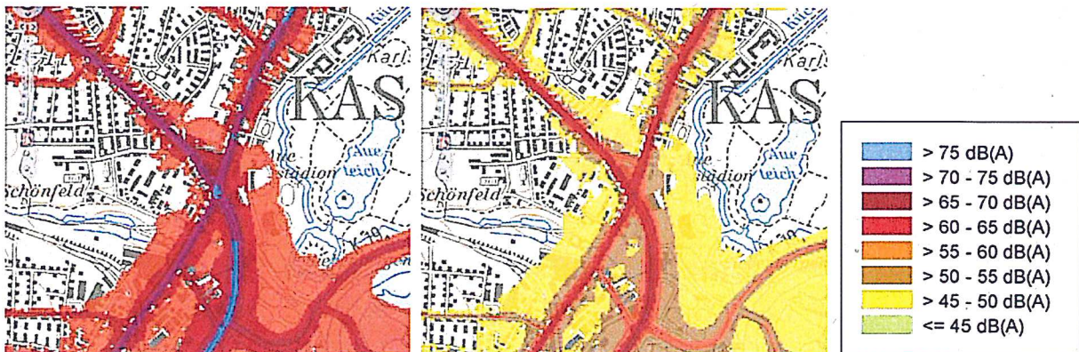
Lärmkartierung Hessen, Straßenlärm in db (A) - links L_{DEN} , rechts L_{Night} Ausschnitt Kartendarstellung HLUg2012
