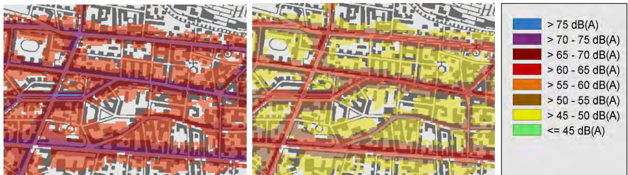
Lärmkartierung Hessen, Straßenlärm in db (A) - links L DEN , rechts L Night Ausschnitt Kartendarstellung HLUg 2012
