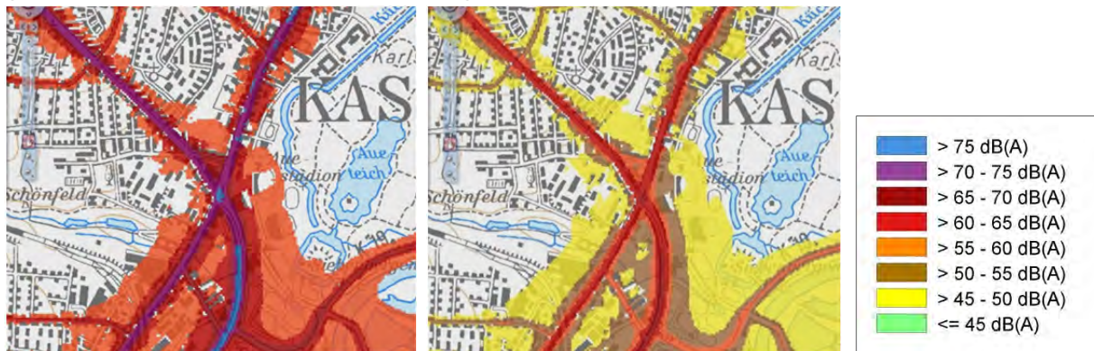
Lärmkartierung Hessen, Straßenlärm in db (A) - links L_{DEN} , rechts L_{Night} Ausschnitt Kartendarstellung HLUg2012
