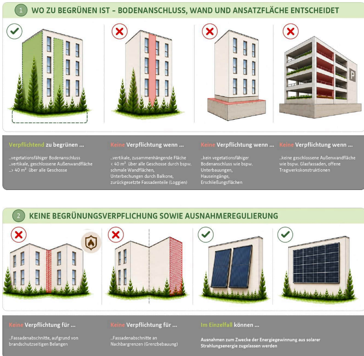
Abb. 83 Prinzipskizze über Vorgaben zur Fassadenbegrünung, pwfAG 35 .
