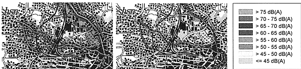
Lärmkartierung Hessen, Straßenlärm in db (A) - links L_{DEN} , rechts L_{Night} Ausschnitt Kartendarstellung HLUG2007
