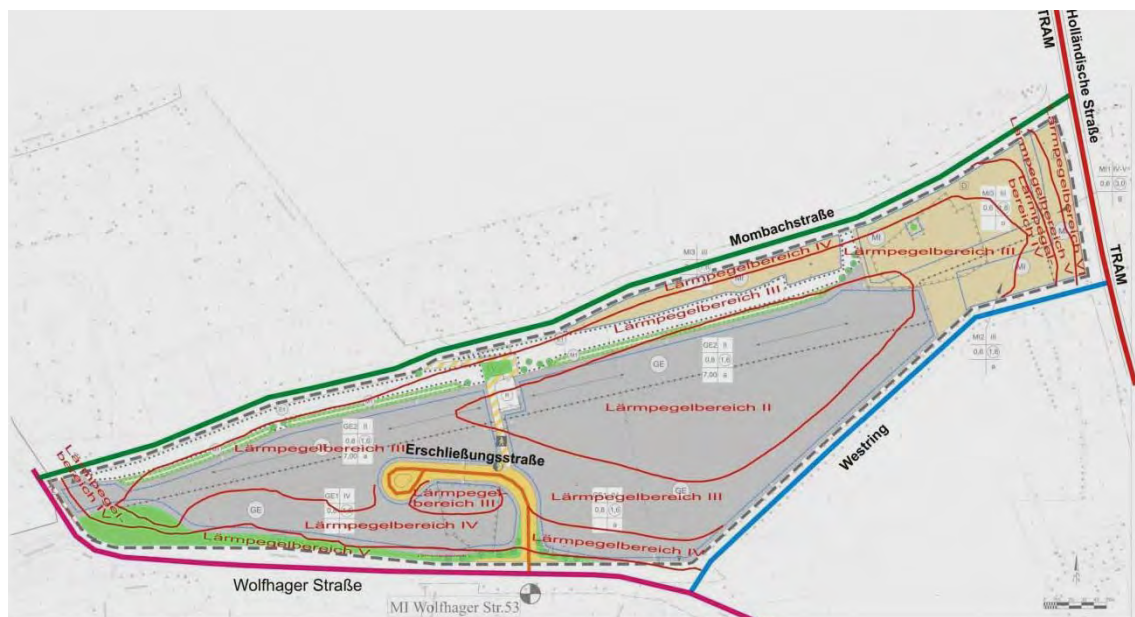
Abbildung 15: Lärmpegelbereiche (Karte 7 des Lärmgutachtens, afi, 2013)
