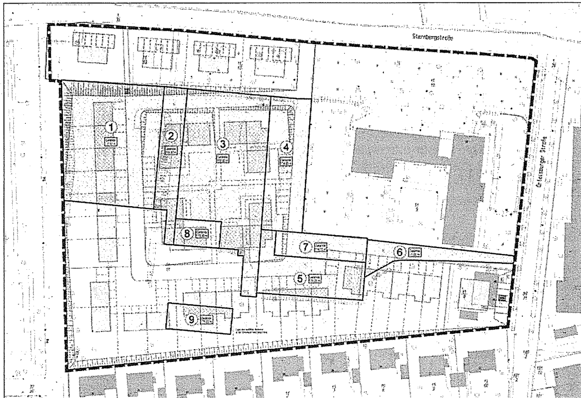
verunreinigte Bereiche mit Angabe der Höhenlage nach Abtrag
