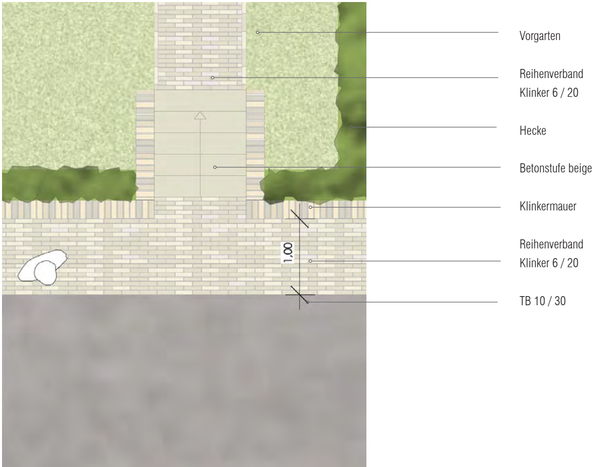
Draufsichtt Sockelmauer M 1:50
