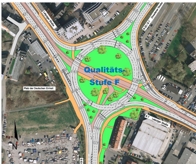
Abbildung 3.3: Einstufung der Verkehrsqualität des Knotenpunktes mit Belastungen des Jahres 2010 nach BBW mit Einstufung der Qualität in Anlehnung an das HBS
