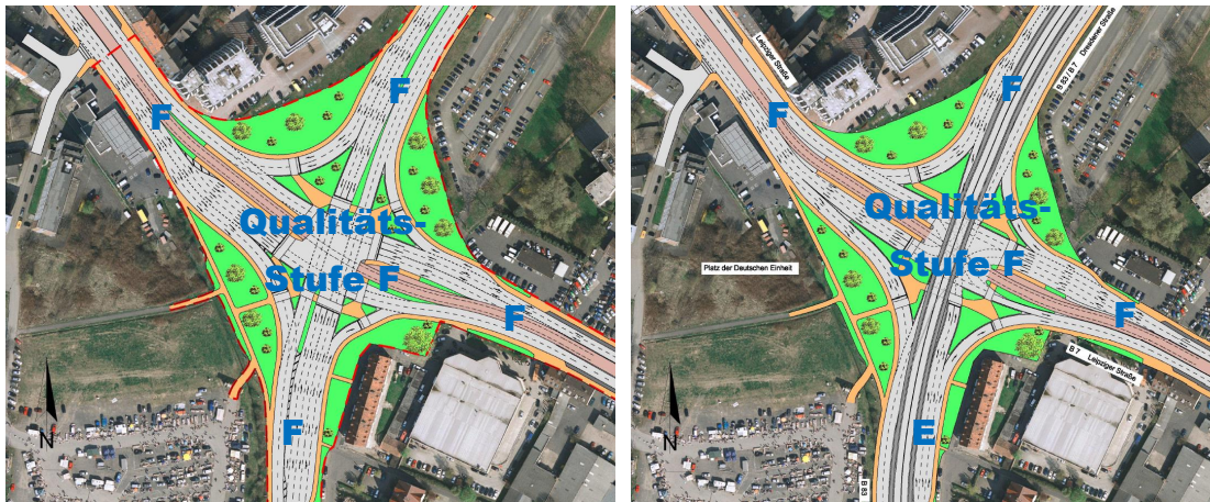
Abbildung 3.4: Verkehrsqualität an den einzelnen Zufahrten und des gesamten Knotenpunktes für das Jahr 2025 mit Verkehrsbelastungen mit Belastungen nach BBW GmbH, links: Lichtsignalgeregelter Knoten, rechts: Lichtsignalgeregelter Knoten mit Brückenbauwerk, nach Handbuch für die Bemessung von Straßenverkehrsanlagen (HBS)
