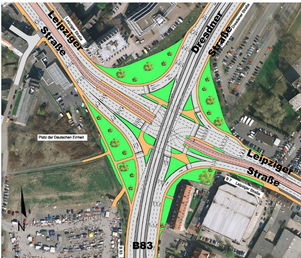
Abbildung 2.3: Planungsvariante 3 „Kreuzung mit Lichtsignalanlage und Überflieger“(V3), Quelle: BBW 2011
