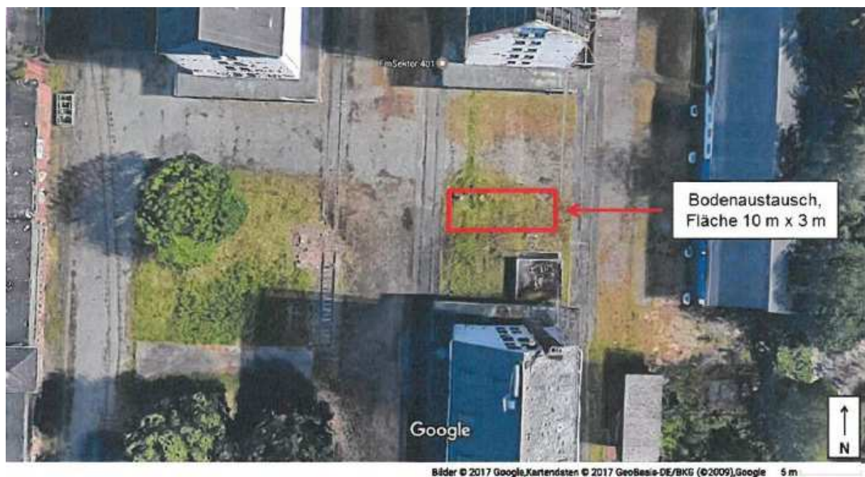
Abbildung 9: Darstellung des empfohlenen Bodenaustauschbereichs 21
