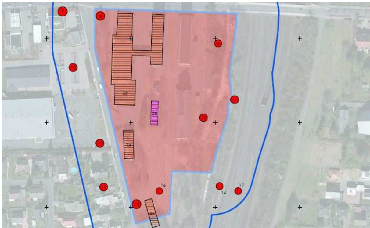
Abbildung 6: Kennzeichnung ermittelter Bombentrichter (rot) sowie der Sicherheitszone (rosa). Der Standort des Löschteichs entspricht der Fläche mit der Nr. 26.
