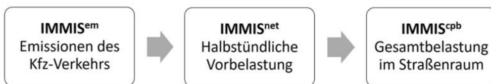
Abbildung 2-6: Schema der Luftschadstoffmodellierung für ein Berechnungsintervall je Straßenabschnitt in IMMIS^{mt}
