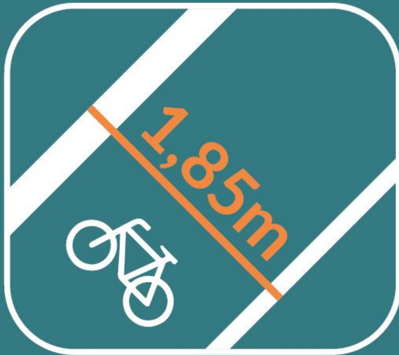
Regelbreite des Radfahrstreifens auf Fahrbahnniveau
