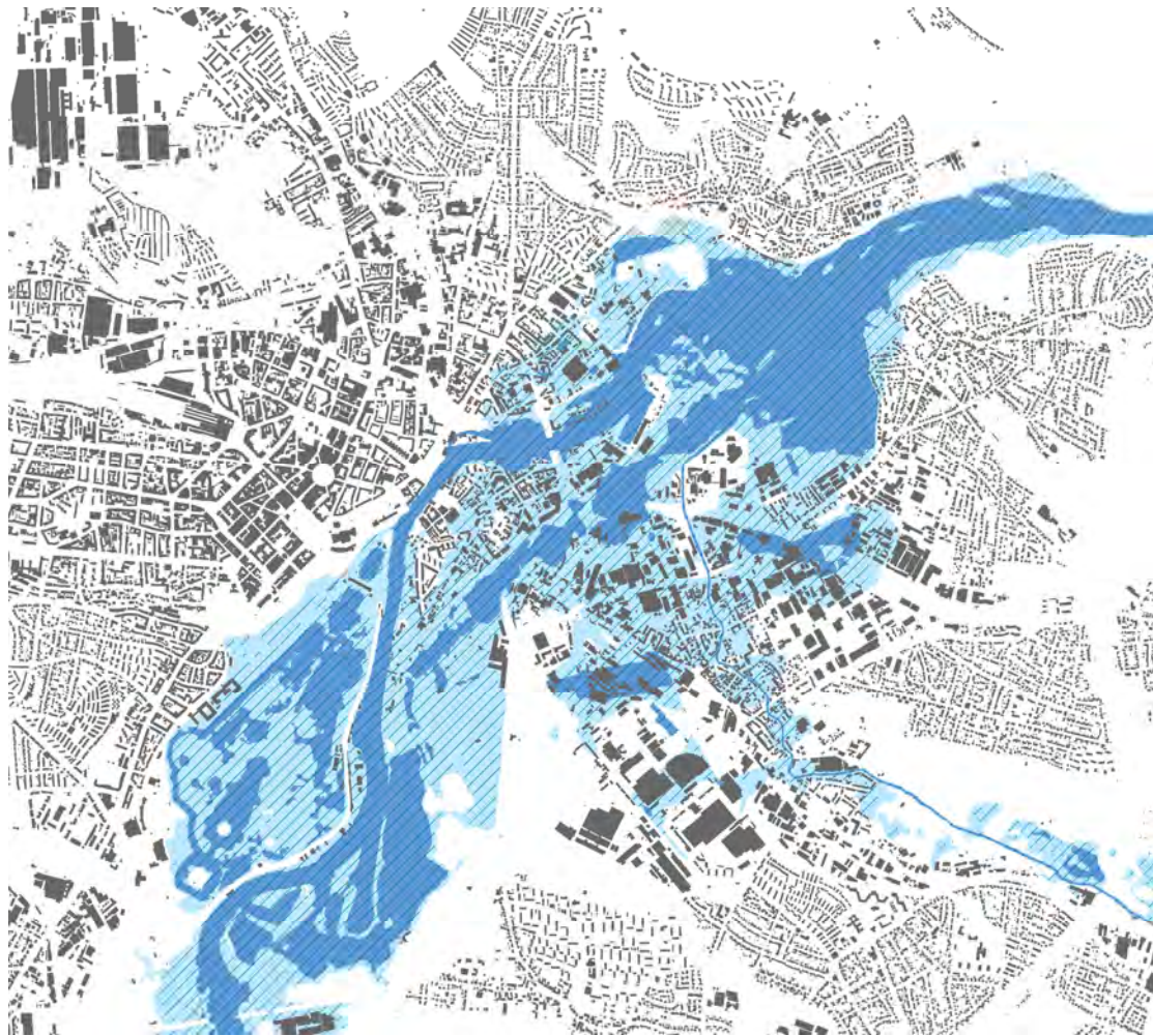
Abbildung 14: Darstellung der unterschiedlichen Hochwassersituationen in Kassel (Hellblau: Hochwasser mit niedriger Wahrscheinlichkeit; Schraffur: Hochwasser mit mittlerer Wahrscheinlichkeit; Dunkelblau: Hochwasser mit hoher Wahrscheinlichkeit).
