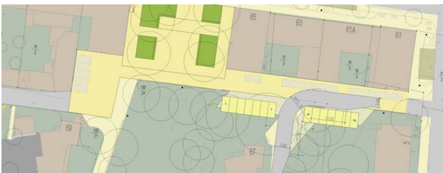
Neuordnung südliche Parallelerschließung, Variante Parkplatzanordnung
