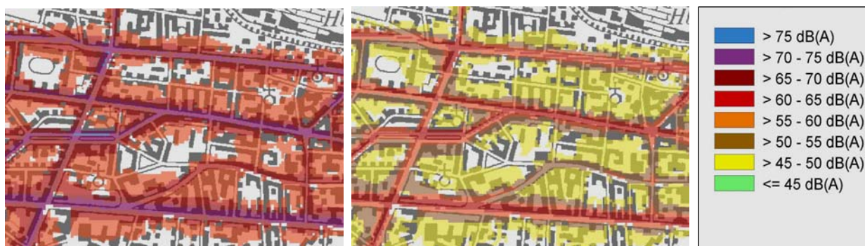
Lärmkartierung Hessen, Straßenlärm in db (A) - links L_{DEN} , rechts L_{Night} Ausschnitt Kartendarstellung HLUg 2012
