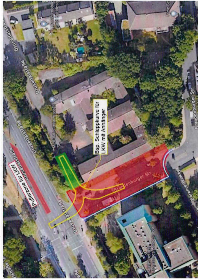
Konzept Einfahrt in Baustelleneinrichtung inkl. Pufferzone
