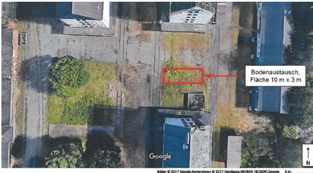
Abbildung 15: Darstellung des empfohlenen Bodenaustauschbereichs 21
