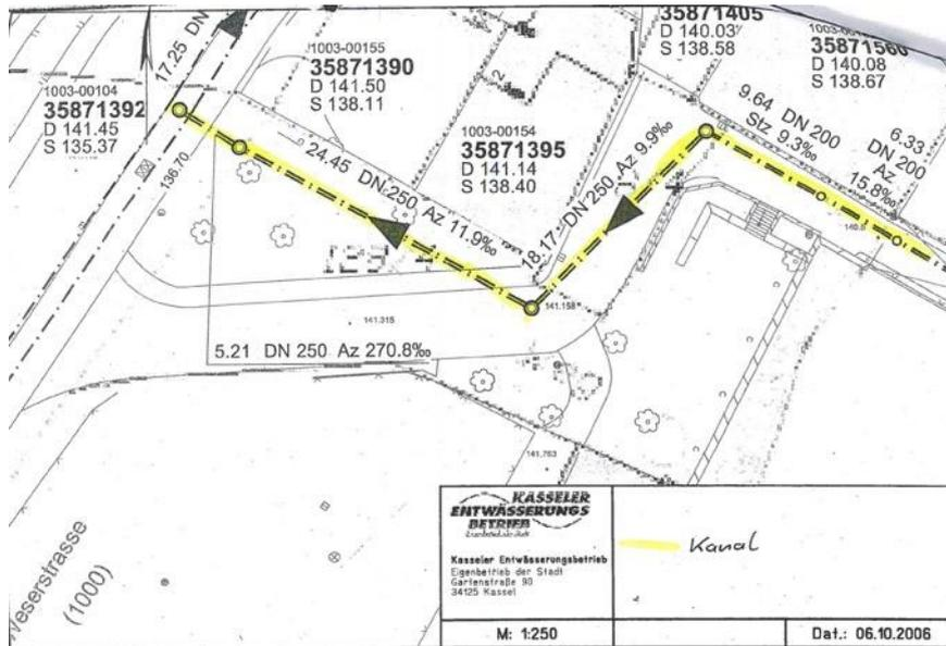
Abbildung 9: Lageplan Abwasserkanal
